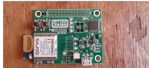
Figure 4. Qorvo (DWM1000) IC Module.
