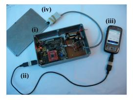
Fig. 2. Oximeter Sensor Prototype
