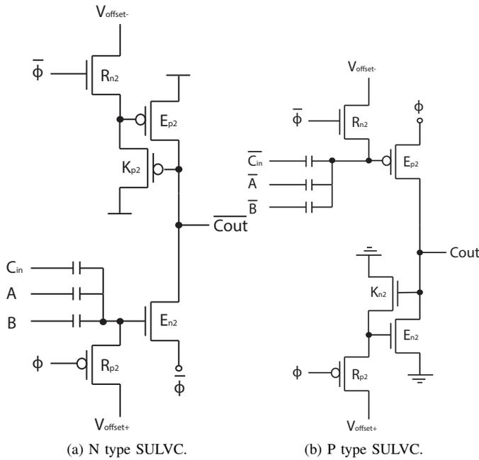
Fig. 16. SULVC circuit.
