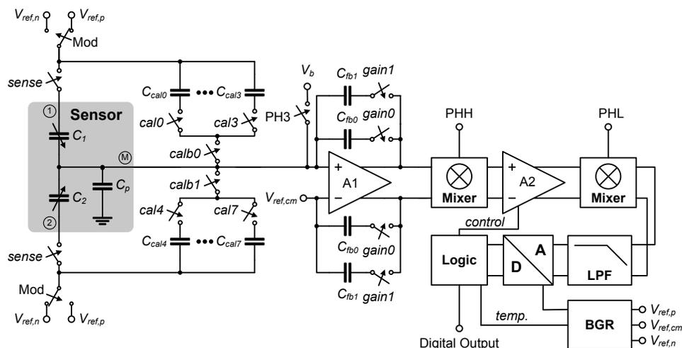
Fig. 8. Accelerometer Frontend.
